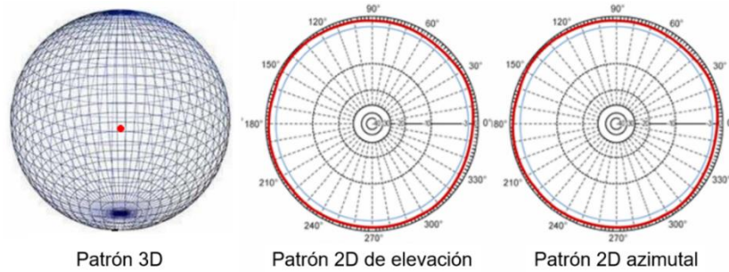
Figura 3.15. Patrón de radiación de una antena isotrópica [30].
