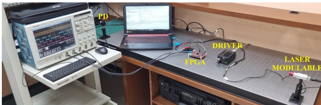
Fig. 5.5. Fotografía del arreglo experimental del enlace de transmisión FSO.
