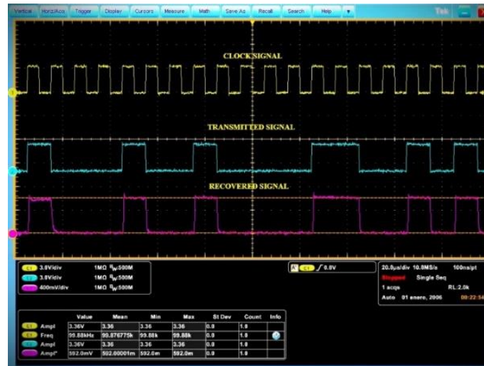
Fig. 5.4. Trazas en el osciloscopio correspondientes a las señales de reloj, transmitida y recuperada.
