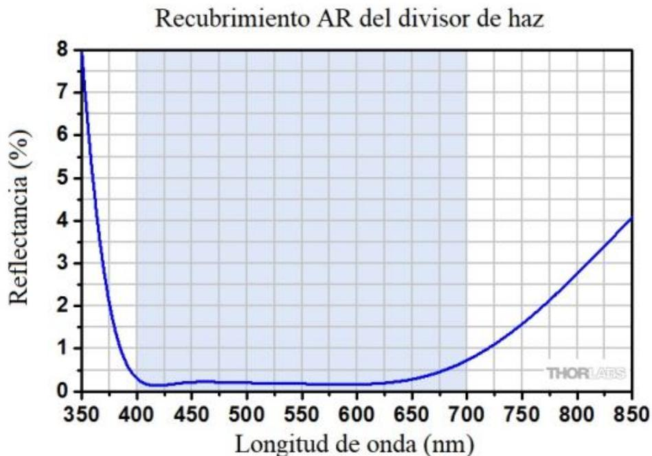
Figura 4.4: Gráfico de la transmisión en cada una de las superficies del interferómetro [39].
