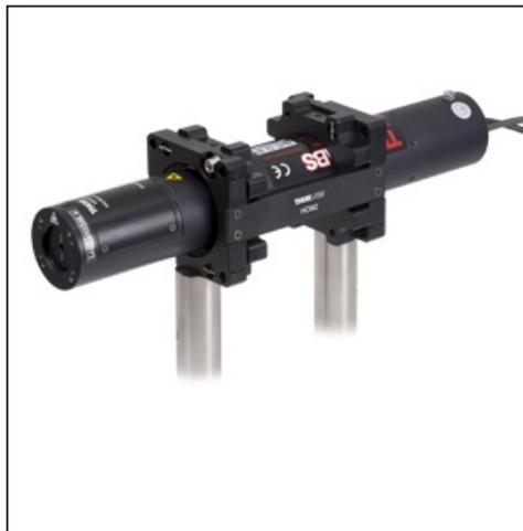
Figura 2.9: Láser utilizado para el interferómetro de metrología (imagen adaptada de [25]).
