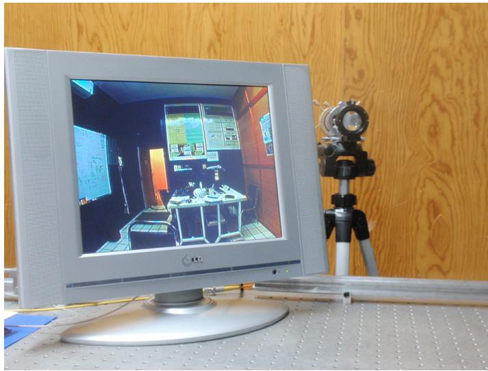
**Figura 5.9:** Enlace óptico de espacio libre transmitiendo video analógico; a) enlace óptico a corta distancia; b) detalle de la recepción y despliegue de video analógico.
