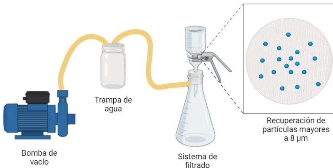
**Figura 10.** Arreglo de filtrado y recuperación de micropartículas
