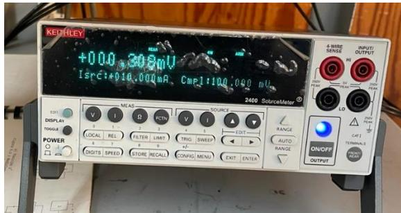
**Figura 5.11** Fuente DC Keithley 2400 utilizada en el laboratorio de microelectrónica.
