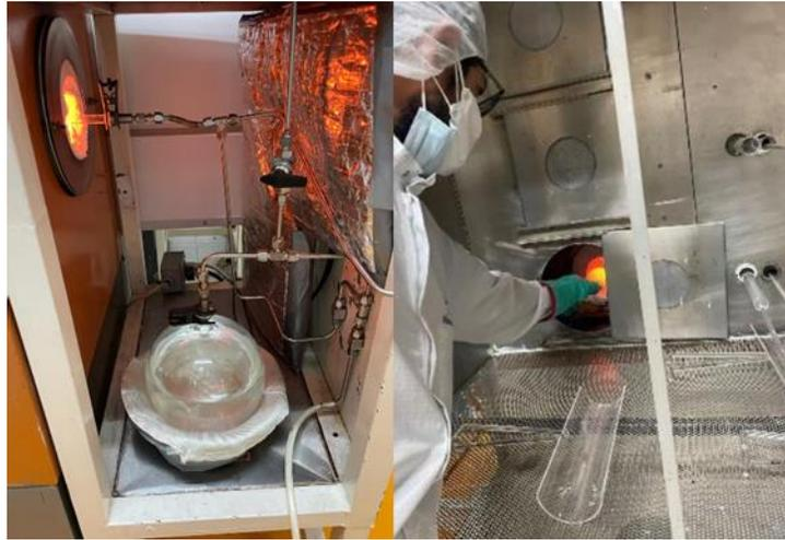
**Figura 4.10** Horno de oxidación húmeda del laboratorio de microelectrónica.
