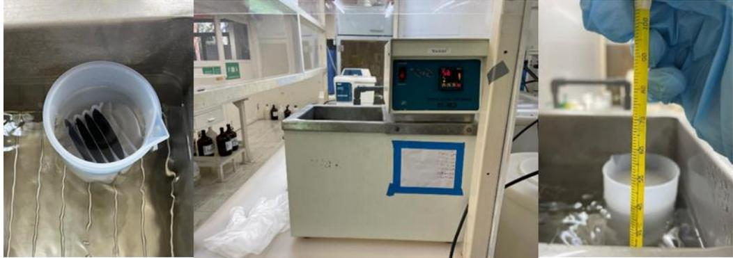
**Figura 4.12** Solución de KOH en baño María. Monitoreo continuo para verificación de temperatura con termómetro manual.
