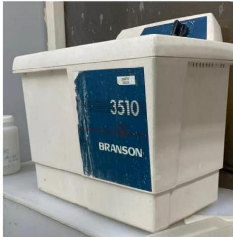
**Figura 4.18** Tina con vibración ultrasónica, Branson 3510.
