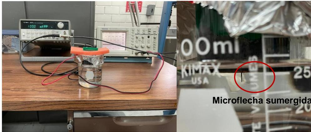
**Figura 5.16** Dispositivo dentro de la solución de Hartmann conectado a un generador de funciones y un osciloscopio.
