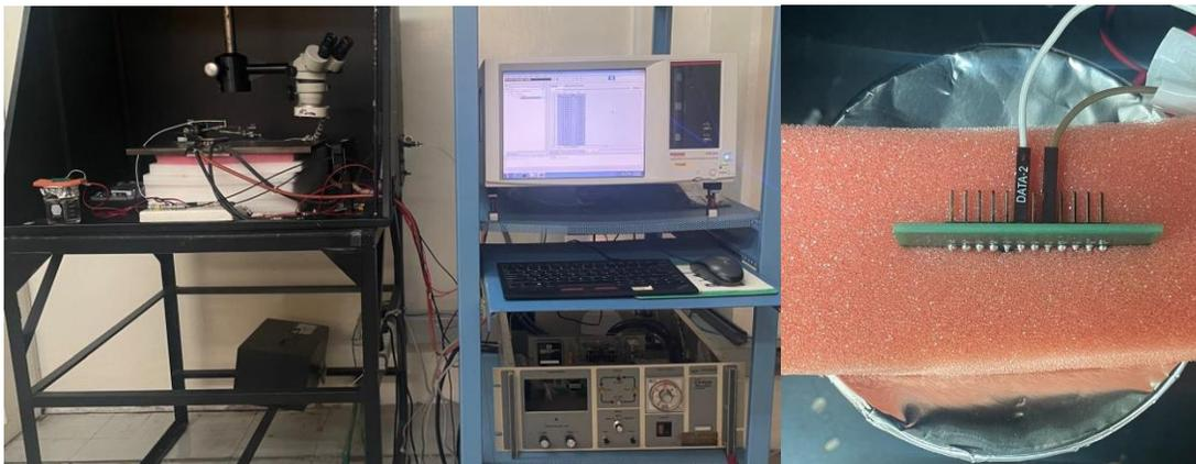
**Figura 5.22** Mediciones de impedancia utilizando el analizador de parámetros de semiconductores y conexión con pines de placa.
