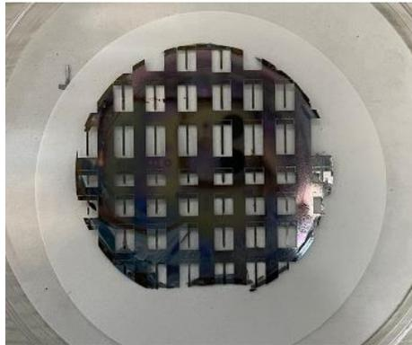
**Figura 4.32** El proceso deja suspendidas las estructuras mediante pivotes.
