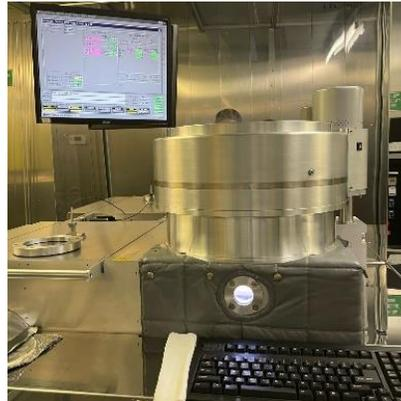
**Figura 2.11** Equipo BOSCH utilizado en el grabado DRIE, laboratorio de Li-MEMS.
