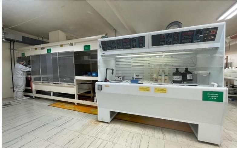
**Figura 2.10** Equipo de grabado húmedo en laboratorio de microelectrónica.
