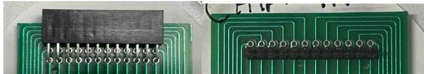
**Figura 4.40** Zona para soldar el arreglo de pines tipo peine para montaje superficial.
