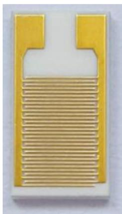
Figura 1.1: Ejemplo de electrodos interdigitados [14].
