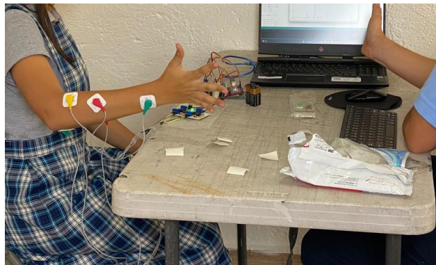
Figura 6.17 Medición de la extensión de la muñeca.
