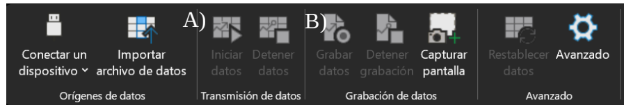
Figura 6.13 Apartado de la cinta de opciones Transmisor de datos. A) Iniciar transmisión de datos B) Almacenar datos
