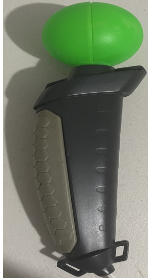
Figura F.1: Gripper: Este sensor tiene una bola verde que sirve para estimar la posición de la mano del paciente a través de una cámara y también se incorpora un sensor de presión que tiene diversas funciones en los juegos.
