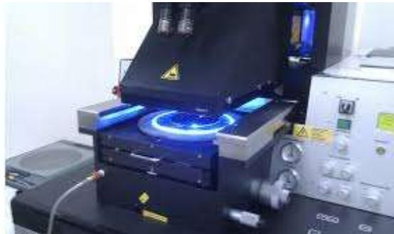
Figura 8. Máquina litográfica por proyección. [63]
