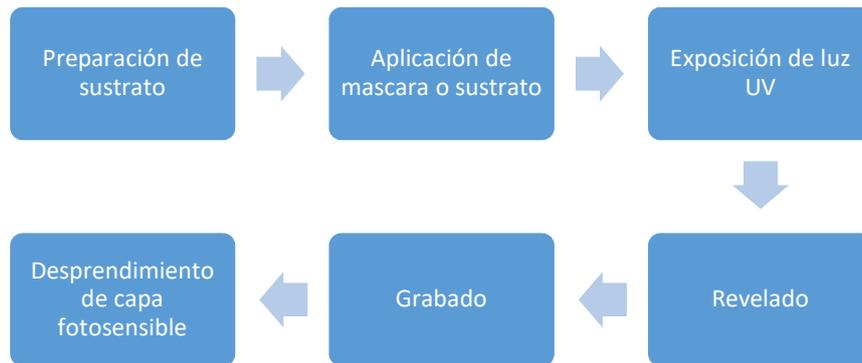
Figura 6. Proceso de fabricación microlentes por litografía.
