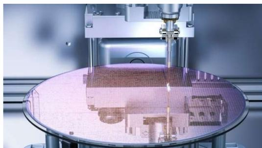
Figura 7. Máquina litográfica para microlentes y circuitos [62].
