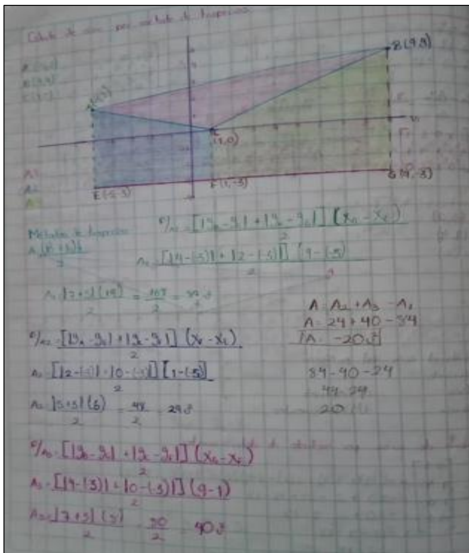
Figura 18. Ejemplo de cálculo de área de un triángulo utilizando método de trapecios dados pares ordenados.
