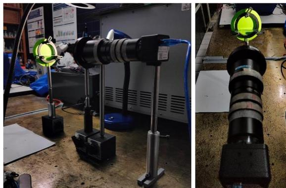
**Figura 12.** Arreglo experimental utilizado para la captura de imágenes y el posterior cálculo del ángulo de contacto.
