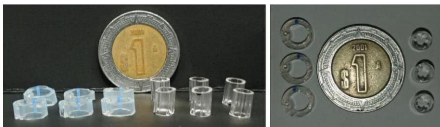
**Figura 11.** Vista lateral y superior de las muestras de silicona y PVC cortadas con una longitud de 2.5 y 5 mm, respectivamente, comparando su tamaño con el de una moneda de \$1 MX. Imágenes propias, obtenidas con dispositivo móvil (ver Sección 3.4).
