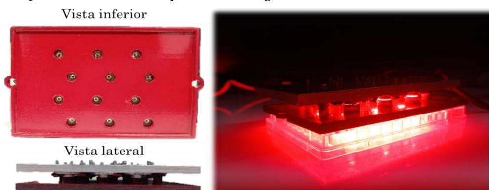
**Figura 15.** Dispositivo LED de irradiación en rojo utilizado en el laboratorio de TFD del INAOE.
