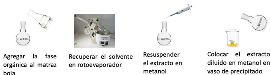
Fig. 10 Evaporación del solvente y obtención del extracto seco.
