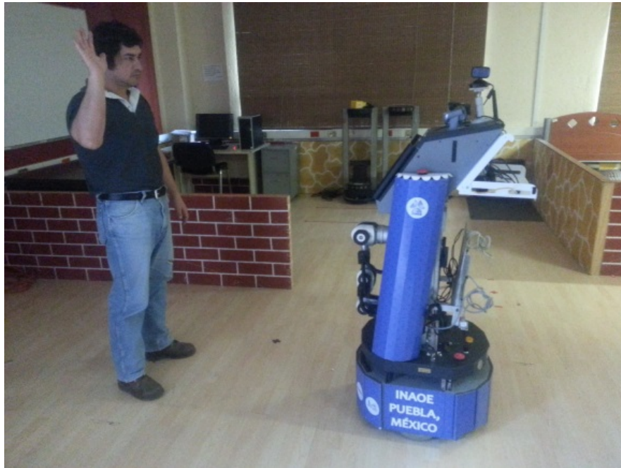
Figura 5.7: Robot Sabina del Laboratorio de Robótica del INAOE. Con el Kinect ubicado en la parte más alta de Sabina, se capturan los ademanes hechos por el usuario.
