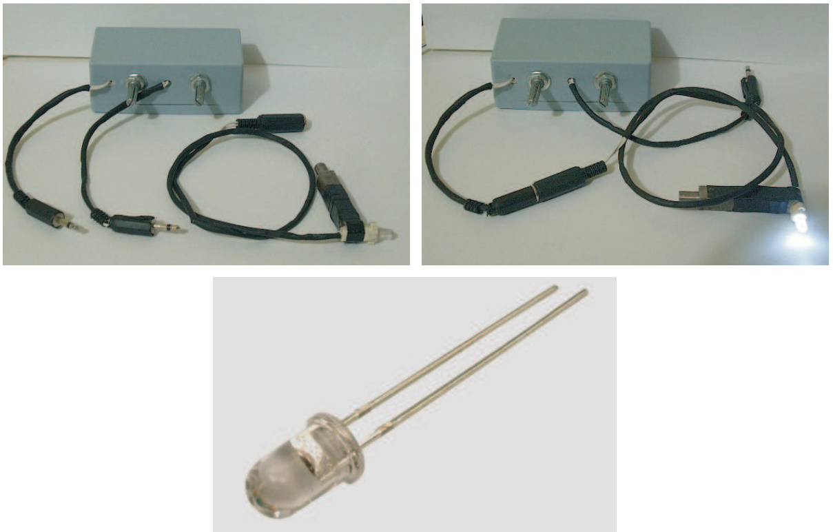
Figura 4.2: Circuito de control y LED ultra brillante utilizados en este trabajo.
