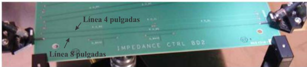
Figura 4.3 Fotografía de las líneas microstrip de 4 y 8 pulgadas medidas.
