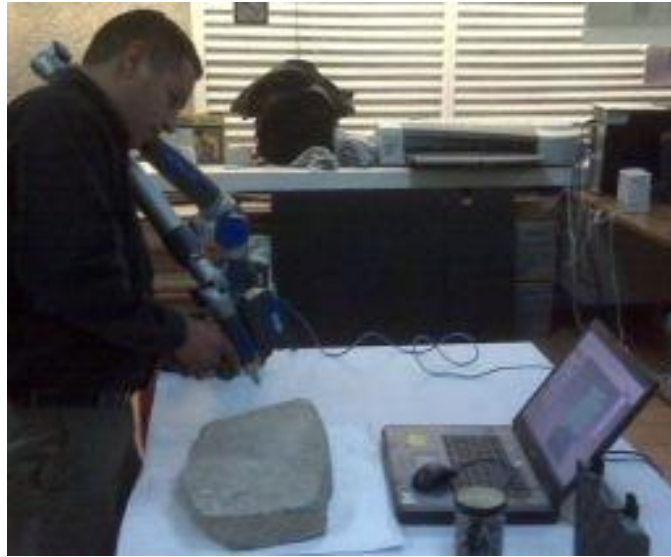
Figura 1.4.- Escaneo por medio de punta exploratoria montada sobre un brazo robot (Joint Arms) 4 .
