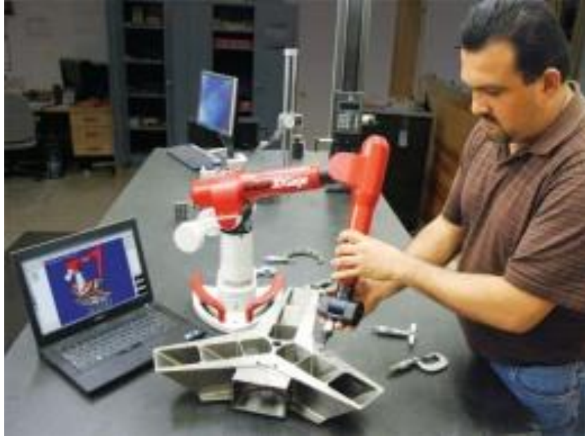
Figura 1.3.- Técnica de digitalización de datos para la construcción de modelos 3D por contacto de Punta montada 3
