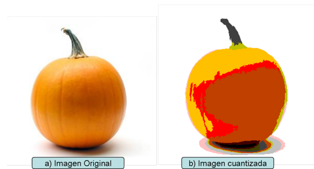
Figura 5.4: Imagen antes y después de la cuantización a 32 colores y eliminación de regiones pequeñas.
