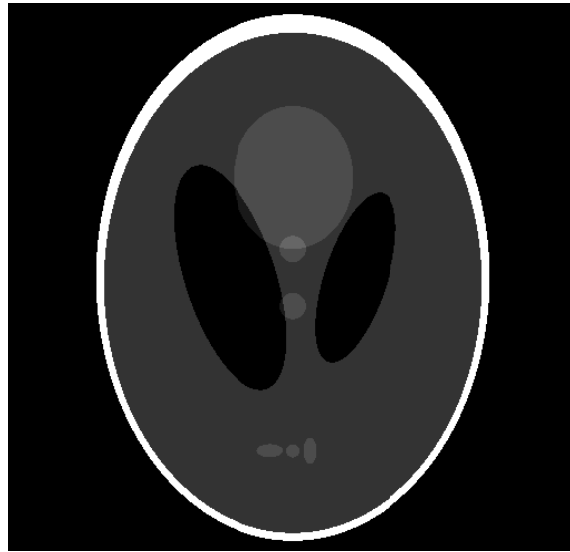
Figura 4.37. Imagen de prueba “head phantom” de Shepp y Logan.
