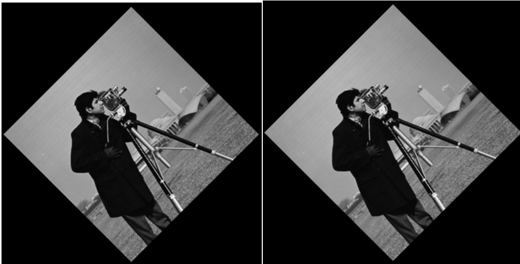
Figura 4.30. Rotación de \theta = 45^\circ con la función de Wendland \varphi_{1,1} con un soporte de 8.
