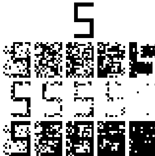
Figura 5.1: 1er renglón, vector ejemplar número ‘5’; 2do renglón, vectores afectados con ruido aleatorio al 25 %, 45 %, 55 %, 75 % y 95 %; 3er renglón, máscaras \tilde{\mathbf{x}}_{+e}^\xi ; 4to renglón, máscaras \tilde{\mathbf{x}}_{+d}^\xi .
