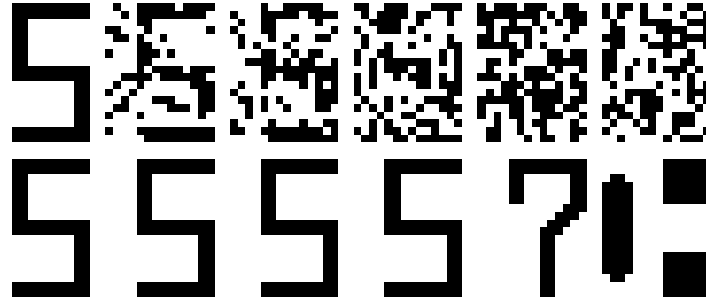
Figura 2.12: 1er. renglón, imágenes de entrada a la red: imagen ejemplar y versiones contaminadas del número '5' con 15 %, 25 %, 35 %, 45 % y 50 % de ruido aleatorio; 2do. renglón, respuesta de la MHC.
