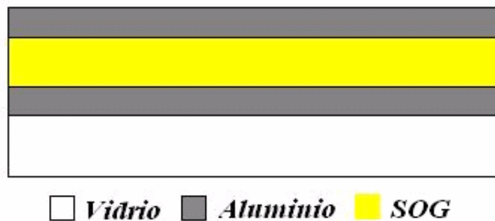
Fig. 3.10 Estructura MIM para obtener la constante dieléctrica del SOG (3:1 2-propanol).
