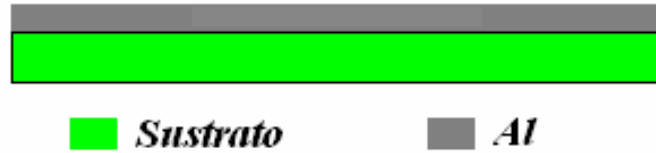
Fig. 3.11 Proceso de fabricación. Evaporación de Al.
