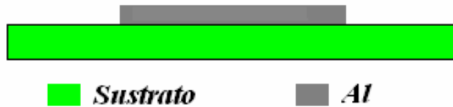
Fig. 3.12 Proceso de fabricación. Litografía de Metal de compuerta.
