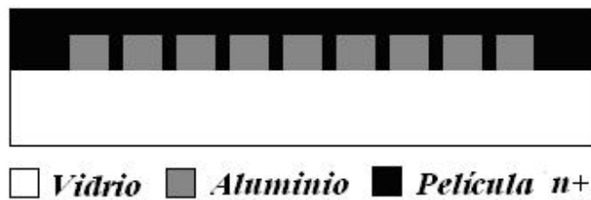
Fig. 3.2 Estructura para medir conductividad en las películas n+.
