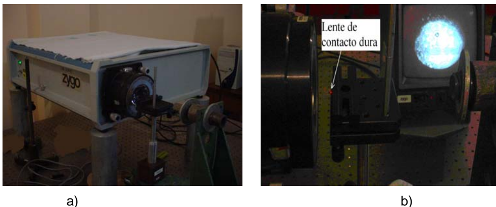
Figura 6.9 a) Interferómetro comercial de Fizeau b) Evaluación de nuestras lentes de contacto duras.
