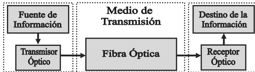
Fig. 1.2 Esquema del sistema de comunicación óptico [2, 4].
