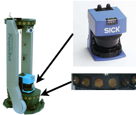
Figura 2.1: Robot Peoplebot de ActivMedia con sensor láser y anillo de sonares
