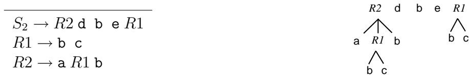
Figura 5.1: Gramática inducida para la secuencia S . S_2 es la secuencia comprimida después del proceso de inducción. La gramática describe la estructura jerárquica de la secuencia, donde R1 y R2 son reglas que pueden verse como sub-conceptos.
