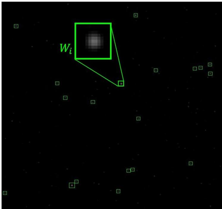
Figura 7.1 Identificación de las estrellas a través del ajuste de una ventana cuadrada  $W_i$
