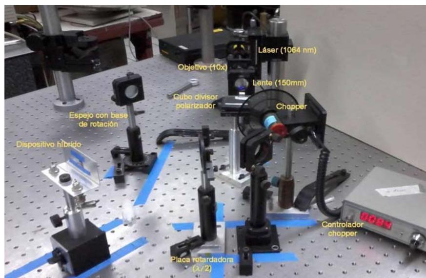
Figura 4.10: Fotografía del montaje experimental para mezcla de dos ondas.
