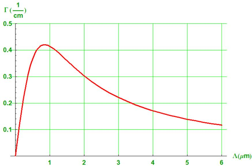
Figura 2.7: Coeficiente de acoplamiento para SI-GaAs con respecto al periodo de la rejilla para  $\lambda = 1,064\mu m$ .
