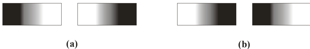
Figura 1.1. Efecto de proximidad de la corriente fluyendo en dos conductores adyacentes; a) modo par y b) modo impar.
