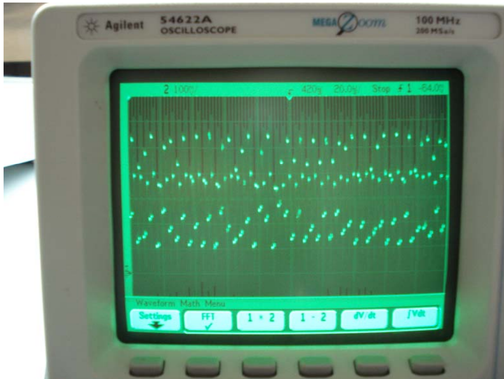
Figura 3.22 Señal caótica obtenida experimentalmente.
