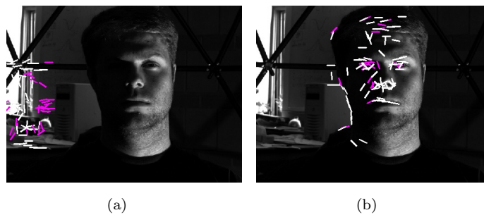
FIGURA 5.7: Ejemplos de imágenes al correr el mismo algoritmo con diferentes parámetros de histéresis, se puede observar que al incrementar los rangos el conjunto \hat{H} tiene mas elementos y por tanto se puede inferir mas acerca del objeto.
