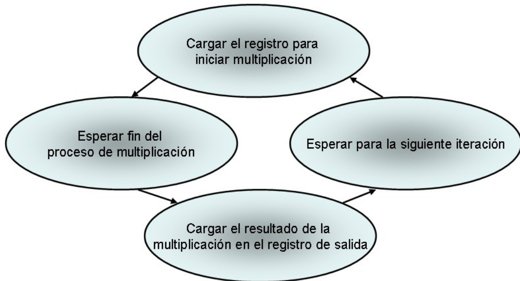
Figura 3.4. Secuencia realizada por el bloque de control.
