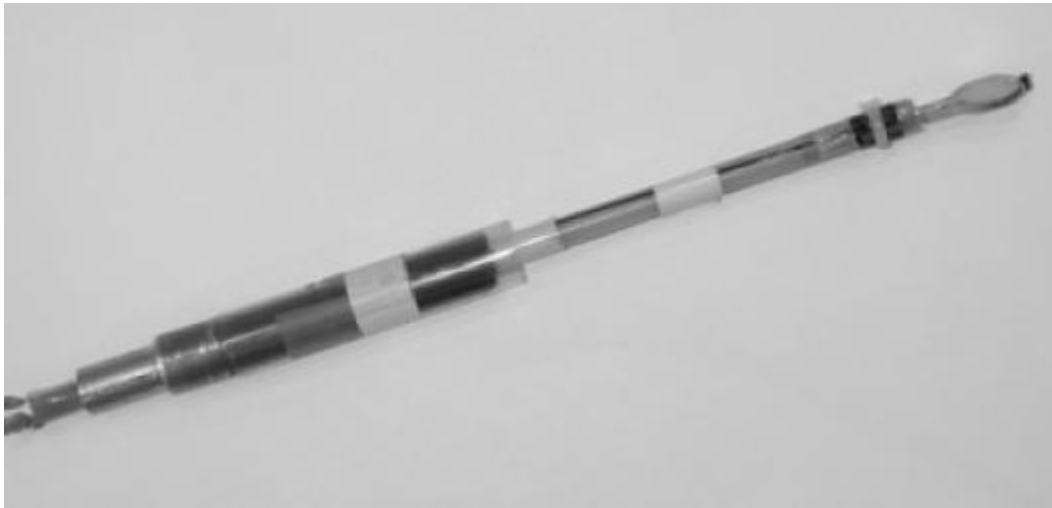
Figura 1.5 Sensor de campo eléctrico de placas paralelas con diodo Schottky.
