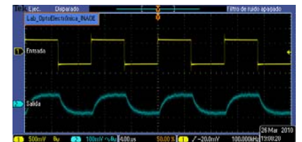
Figura 5.27. Ejemplos de señales adquiridas en el experimento de detección de campos eléctricos por modulación en coherencia. Amarillo: Señal de entrada, Azul: Señal detectada
