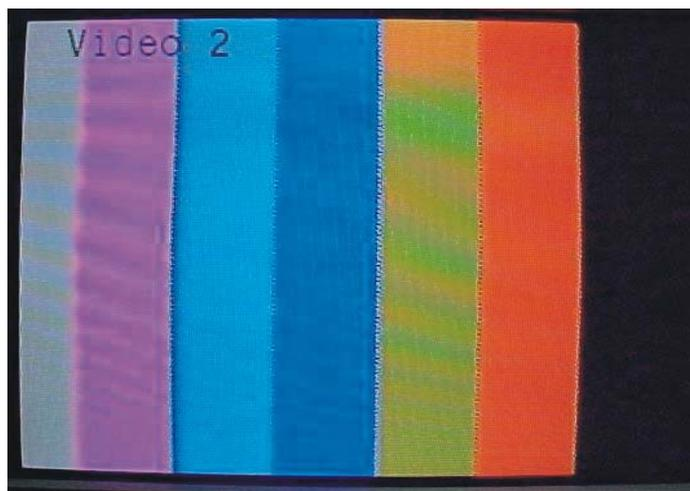
Fig. 4.37 Reproducción de la señal de video compuesta del macropixel (1,2)
