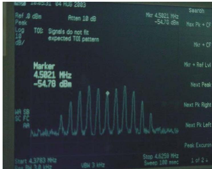
Fig. 4.10 Señal portadora de audio modulada en frecuencia para una señal de vídeo compuesta.
