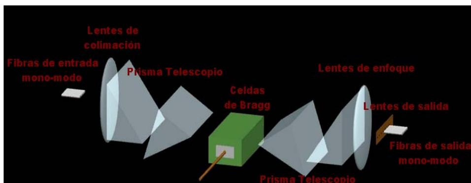
Fig. 1.6 Conmutador acusto-óptico.
