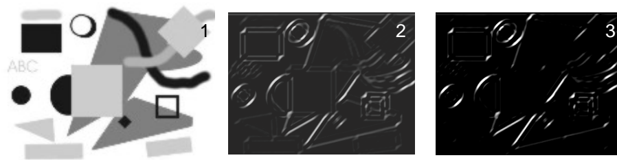
Fig. 4.2 A la imagen original (1), después de aplicar el filtro Gabor (2) se aplica una cuantización (3) para reducir los niveles de gris, de 256 a 8 niveles.
