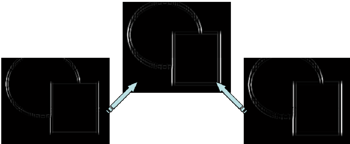
Fig. 2.5 En los extremos dos imágenes en escalas 7 y 9 y orientación 0° de la primera banda. En el centro, el resultado de aplicar la función max.
