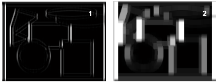
Fig. 2.6 En 1: imagen antes de aplicar el Max local. En 2: imagen después de aplicar el Max local.
