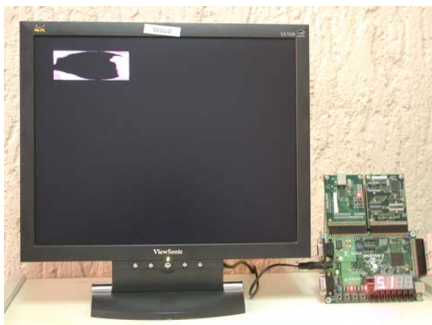
Figura 5-7 Imagen obtenida de la implementación hardware para la imagen de la figura 5-2h
