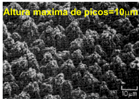
Figura 2.9: Fotografía de la rugosidad que presenta el conductor (cobre) depositado sobre FR4, la altura máxima de los picos es de 10 \mu\text{m} , y es debida a la topografía del sustrato [11]
