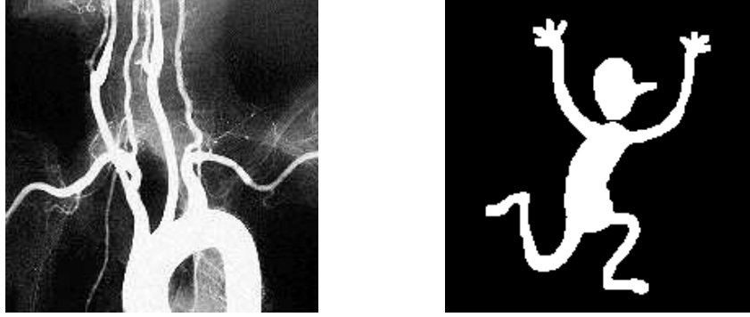
Figura 1.3: clasificación de las imágenes considerando su intensidad; izq., imagen en escala de grises; der., imagen binaria. Ambas imágenes son de tamaño 192 \times 192 píxeles.
