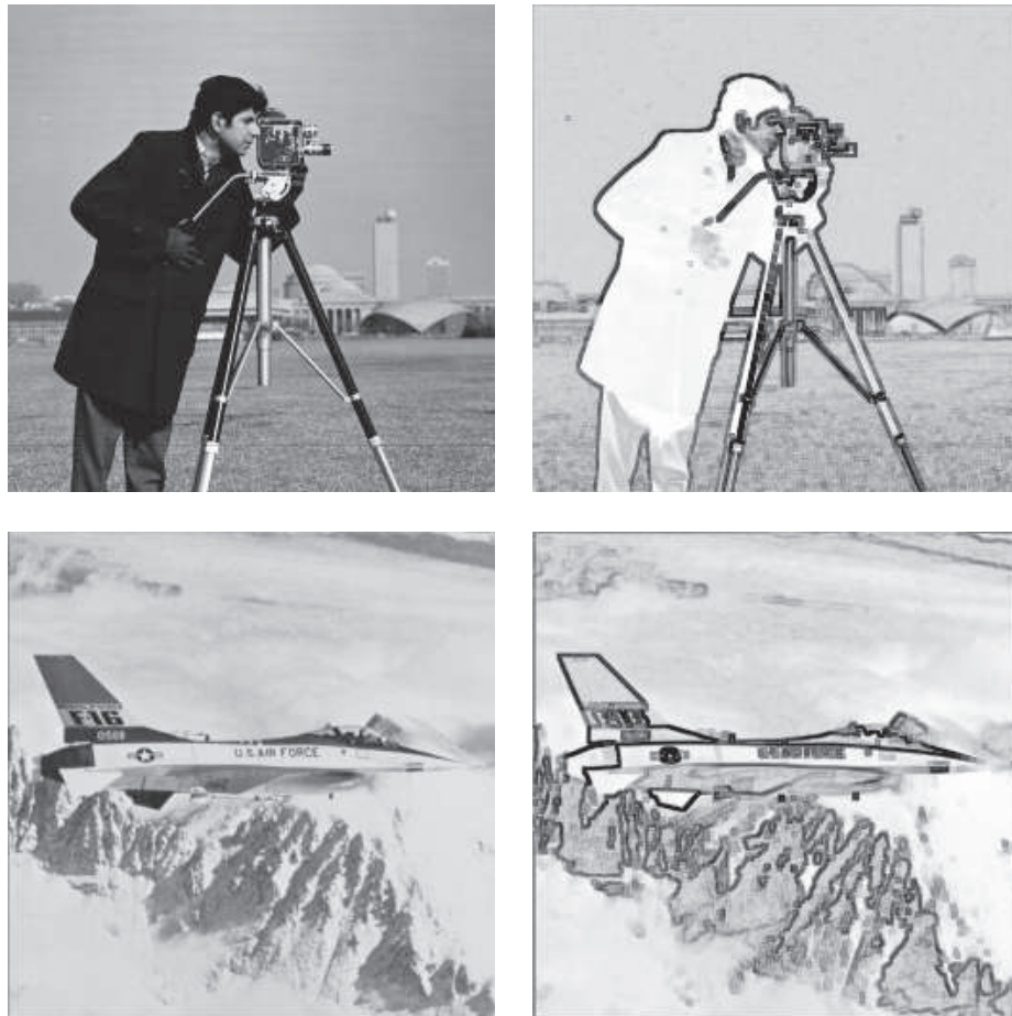
Figura 4.15: detección de bordes mediante operadores morfológicos difusos; izq., imagen original, der., bordes de la imagen original utilizando el conjuntor M y el implicador I_{KD} . Las dos imágenes presentadas son de tamaño 256 \times 256 píxeles.
