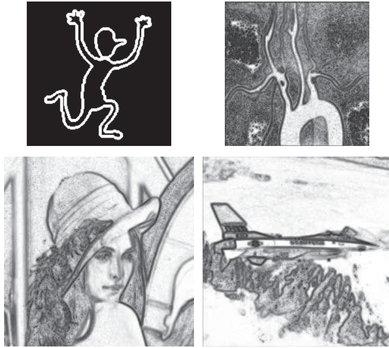
Figura 4.8: caracterización de bordes utilizando una ventana de 5 \times 5 píxeles. En estas imágenes se aplicó el operador de concentración.
