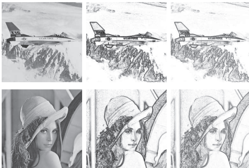
Figura 4.6: imágenes en tonos de gris; de izq. a der., imagen original, resultado del intensificador de Zadeh, resultado del operador de concentración. Ambas imágenes son de tamaño 256 \times 256 píxeles.
