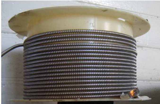
FIGURA 1.6: Carrete de fibra óptica. Se observa el recubrimiento de acer inoxidable y, de frente, el cabezal de acero que contiene el arreglo lineal de fibras.
