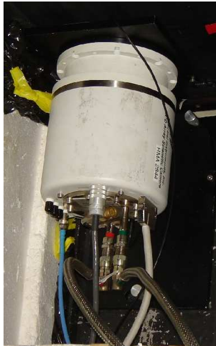
FIGURA 1.7: Aspecto externo de la cámara de vacío del detector. Se observan los cables de alimentación y de transmisión de datos y las mangueras del sistema de autoenfriamiento.
