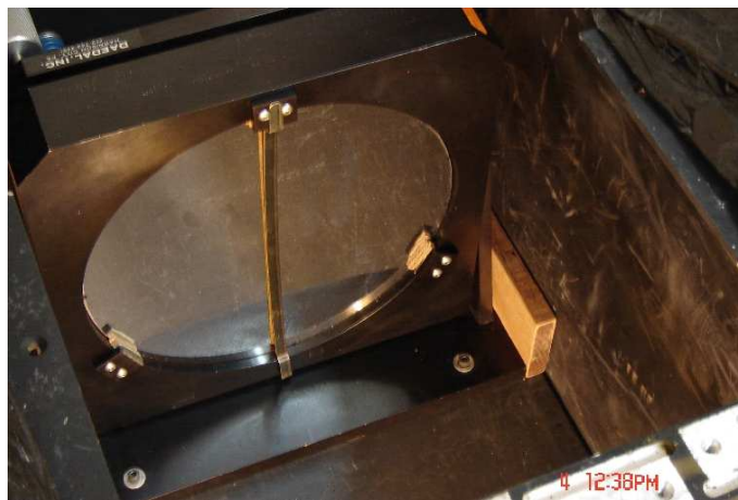
FIGURA 2.3: Establecimiento del eje óptico del espectrógrafo, por medio del eje óptico del espejo.
