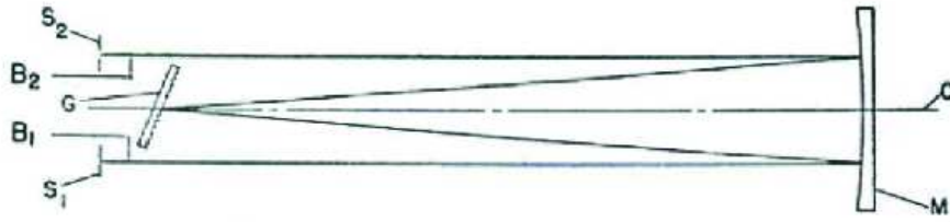
FIGURA 1.2: Arreglo óptico de Fastie (Fastie, 1952) mostrando sus componentes ópticos. M_1 es un espejo cóncavo esférico, G es una rejilla plana, B_1 y B_2 son reductores de circulación de luz, y S_1 y S_2 son las rendijas de entrada y salida en el plano focal del espejo cóncavo.
