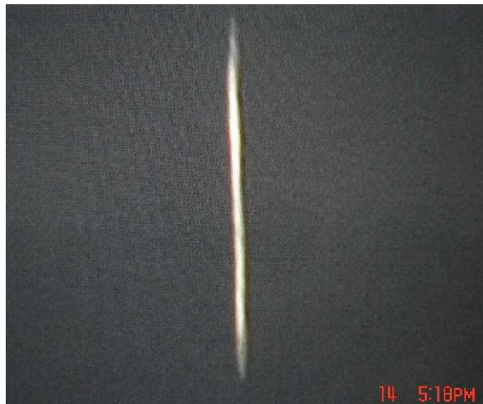
FIGURA 2.9: Imagen de la rendija iluminada con luz del Sol, captada con el CCD Hitachi. En la imagen se observa que el camino óptico es el correcto, aunque aun la imagen está fuera de foco.
