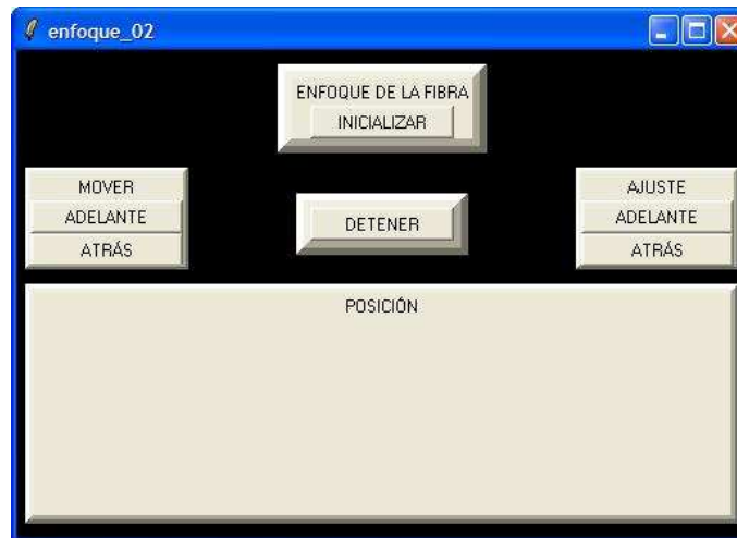
FIGURA 2.15: Ventana de la interfase entre el usuario y el módulo de control para el enfoque de la fibra. Se observan los botones de comando para inicializar y para recorrer la rendija alejándola y acercándola del foco, tanto en movimientos largos como finos, y un botón de paro en caso de requerirse detener cualquier tipo de movimiento.
