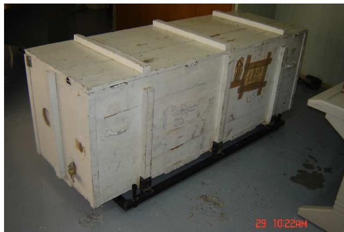
FIGURA 2.2: Aspecto externo del espectrógrafo luego de ser colocado en el laboratorio de electrónica y sobre la base de nivelación. Se observa, en la esquina inferior izquierda, visto de lado, uno de los tornillos de nivelación de la base.
