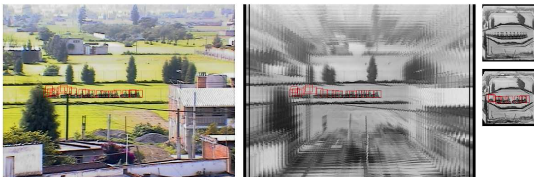
Figura 5.7: Seguimiento de un objeto sobre la imagen foveal con fovea fija
