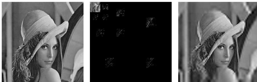
Figura 2.10: Aplicación de la Transformada Wavelet Foveal, a la izquierda imagen original, al centro descomposición piramidal utilizando la Transformada Wavelet con los filtros y a la derecha, reconstrucción de la imagen con el efecto foveal
