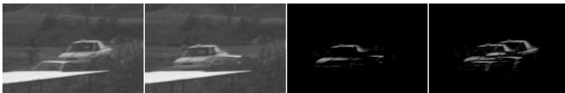
Figura 3.1: Diferencia de imágenes para detectar movimiento, en orden: imagen anterior, imagen actual, diferencia de actual con anterior, y diferencia absoluta
