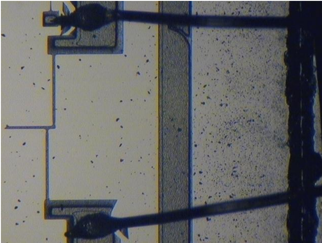
Fig. 2.21 Detalle del alambrado sobre los pads de los actuadores.
