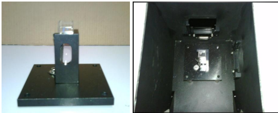
La celda de cuarzo en su base y la celda de cuarzo instalado dentro del espectrofluorómetro.
