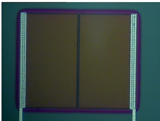
Figura 2 – Chip del sensor desarrollado en el INAOE/CNM.
