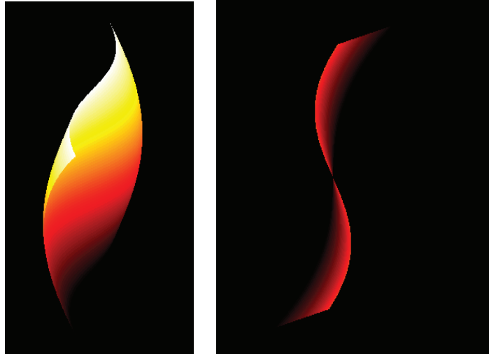
Figura 4.15: frente de onda de la aberración de coma.
