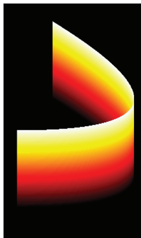
Figura 4.13: Frente de onda de la aberración de astigmatismo.
