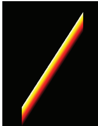
Figura 4.18: Frente de onda de la aberración de tilt.
