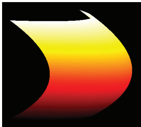
Figura 4.7: Frente de onda con aberración de curvatura de campo después de pasar por la lente.
