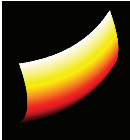
Figura 4.19: Frente de onda propagado con aberración de tilt.
