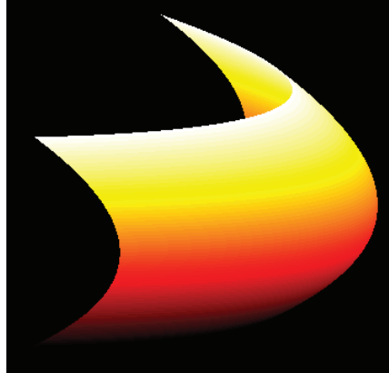
Figura 4.12: Frente de onda de la aberración de astigmatismo despues de la lente.
