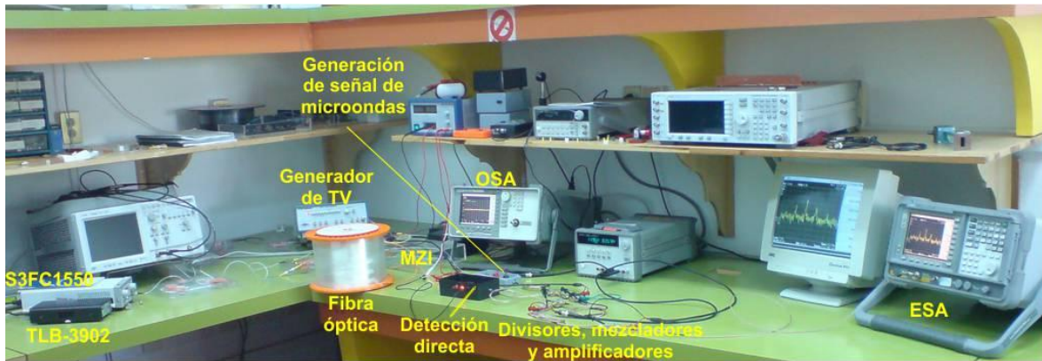
Figura 4.12 Arreglo experimental para la transmisión de video por fibra óptica.
