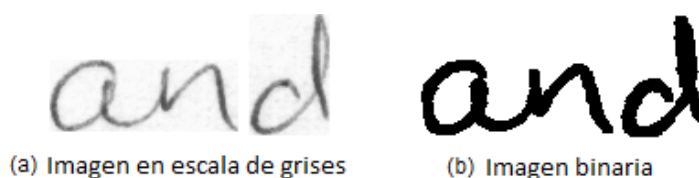
Figura 2.2 Ejemplo de binarización de una imagen. (a) imagen tomada de la base de datos IAM-DB (Martí & Bunke, 1999). (b) imagen binarizada.
