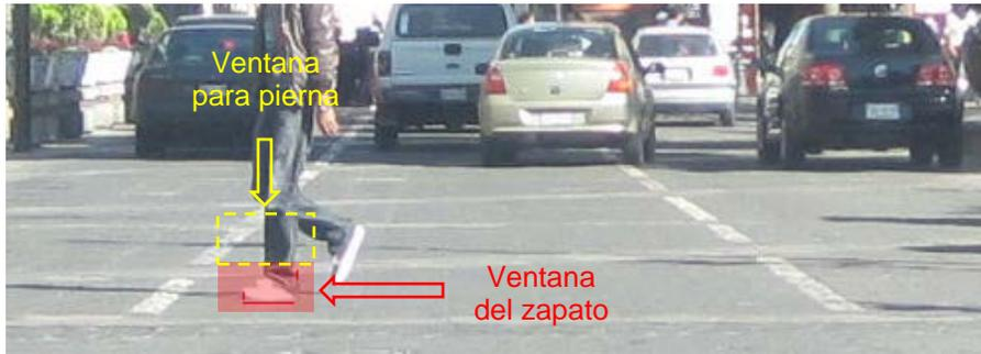
Fig. 3.37: Reposicionamiento de ventana para detección de pierna.
