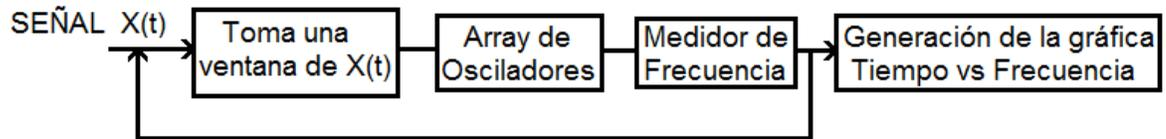
Figura A1. Funcionamiento del sistema completo.
