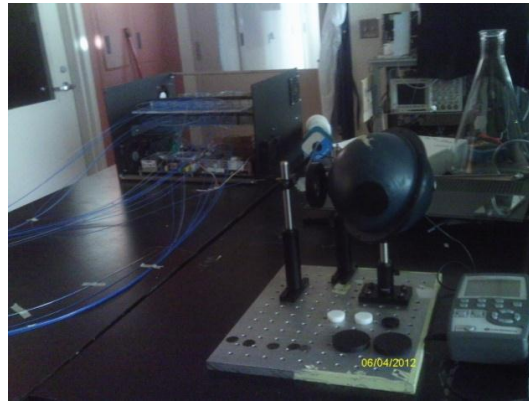
Figura 4.3 Sistema para medir propiedades de reflexión difusa mediante una esfera integradora
