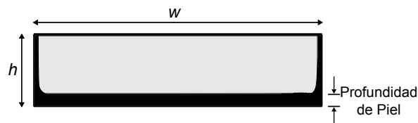
Figura 2.4: Distribución de la corriente en una línea de transmisión “ Microstrip ”
