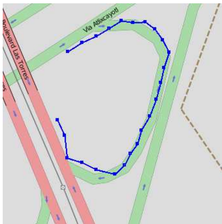
Figura 4.22: Corrección de una curva con inconsistencias. Dibujado con GPSPPrune
