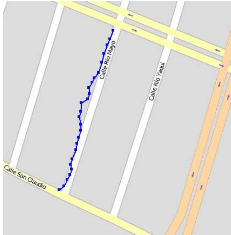
Figura 4.18: Trazo de recta a corregir con puntos GPS inconsistentes. Dibujado con GPSPruve
