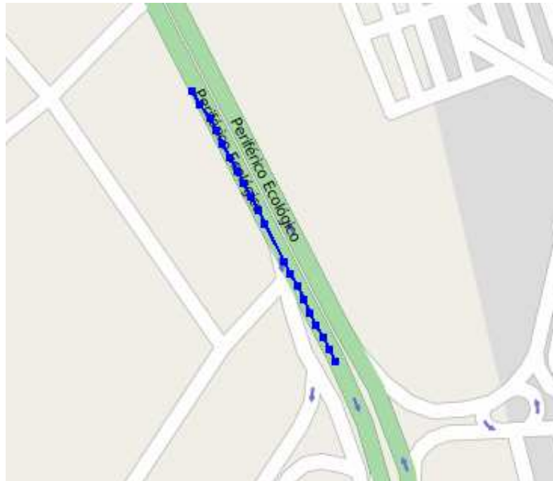
Figura 4.17: Trazo de recta sin puntos de GPS inconsistentes. Dibujado con GPSPRUNE
