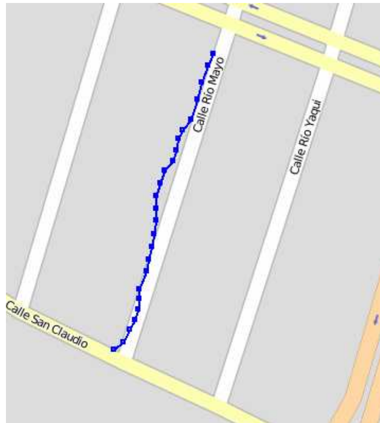
Figura 4.19: Corrección de una recta con inconsistencias. Dibujado con GPSPPrune
