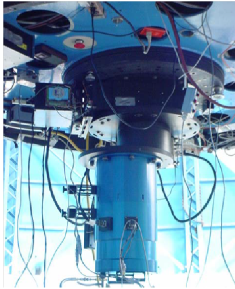
Figura 3.1: Fotografía de CANICA con el adaptador sujeto al guiador del telescopio de 2.1 m en Cananea, Sonora.
