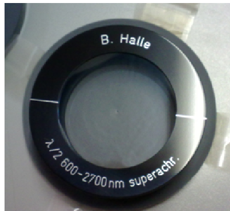
Figura 3.7: Placa retardadora superacromática de media onda. B. Halle
