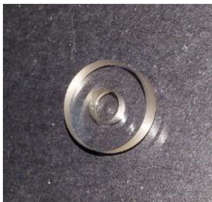
Figura 4.15: Imagen del objeto real del cual se obtuvo su perfil topográfico en la figura 4.17. Donde además es fácil apreciar la pendiente en la superficie del objeto.
