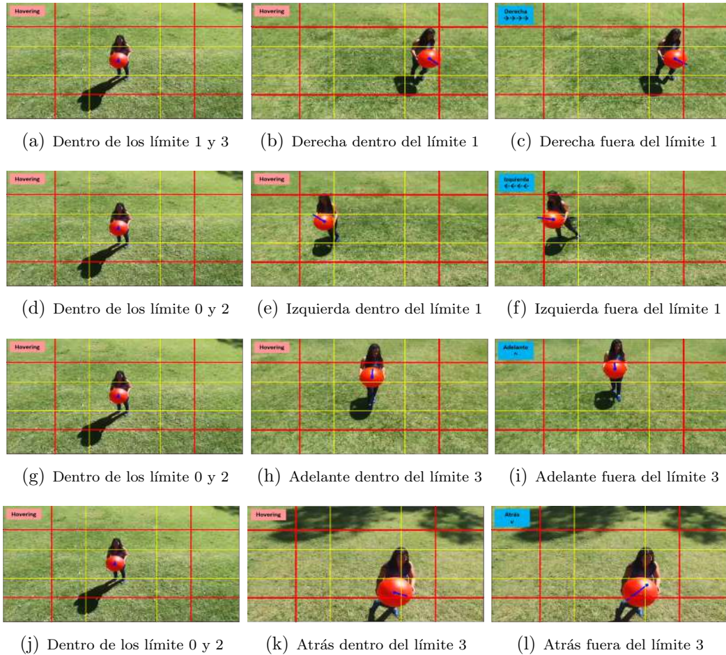
Figura 5.10: Respuesta del segundo enfoque propuesto observada desde el dron cuando el objetivo está en diferentes posiciones.
