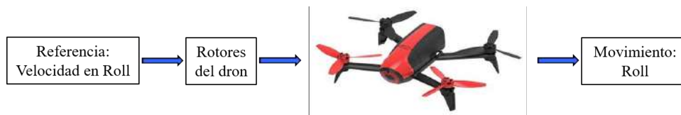
Figura 4.7: Control de lazo abierto (control reactivo) para movimientos en roll del dron.
