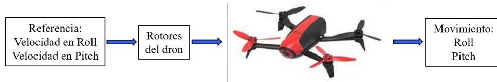
Figura 4.11: Control de lazo abierto (control reactivo) para movimientos en roll y pitch del dron.
